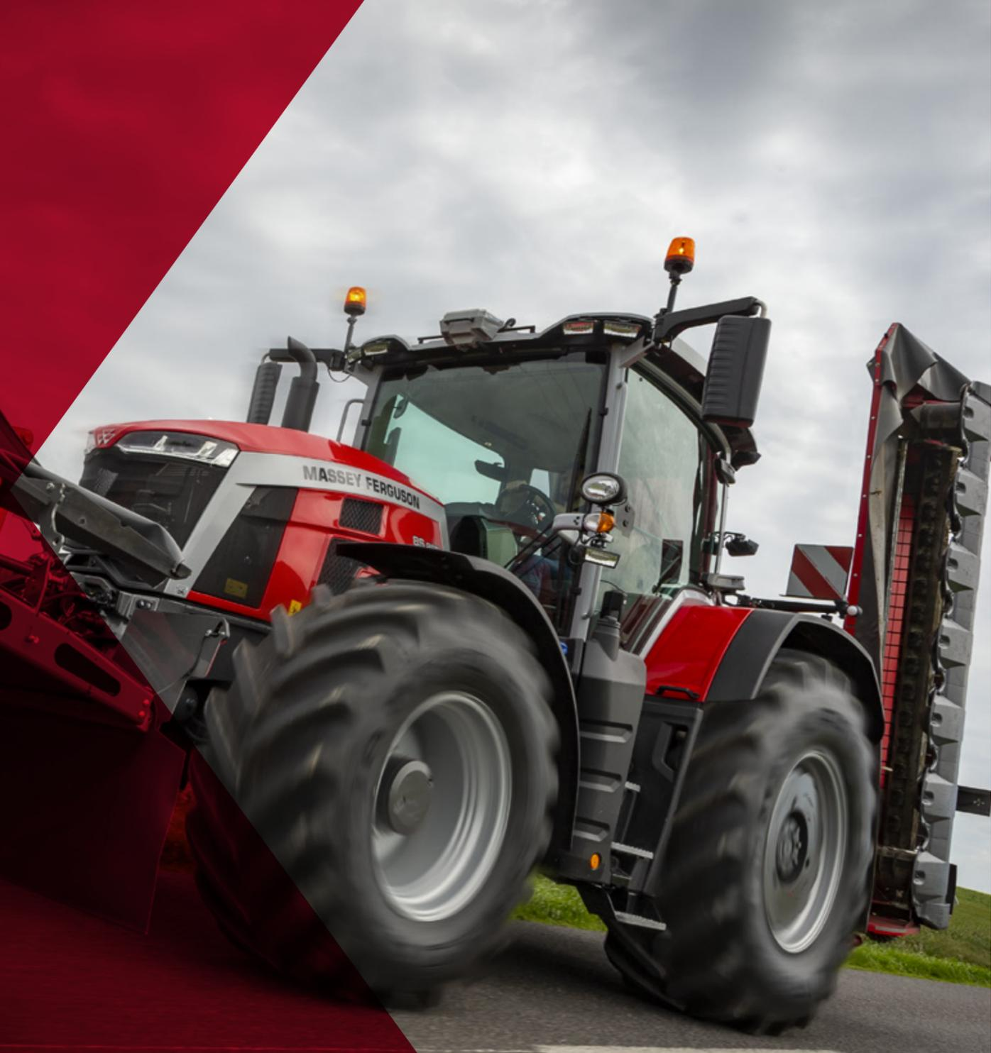
La nueva transmisión Semi-Powershit Dyna-7 de Massey Ferguson se basa en el sólido legado de la transmisión Dyna-6, famosa por su **rendimiento** y su **eficiencia**. Su mayor refinamiento no solo le proporciona una velocidad Powershift adicional y una mayor suavidad en los cambios de marcha, sino también un **15 % más de eficiencia con respecto a la Dyna-6**.
