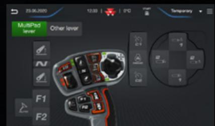
Asignación de los comandos del apero ISOBUS a la palanca MultiPac: los aperos ISOBUS pueden controlarse directamente mediante la palanca MultiPac. Tener todos los controles (tractor y apero) en la misma palanca es mucho más cómodo que tenerlos repartidos entre varias pantallas y palancas.
