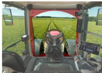
**LOS ESPEJOS RETROVISORES LATERALES** presentan una sección superior e inferior ajustable que ofrece la mejor visión durante el transporte y reduce los puntos ciegos. Hay espejos retrovisores calefactados y con ajuste electrónico disponibles como opción.
