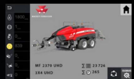
Control total de los aperos mediante ISOBUS: ISOBUS permite visualizar en la pantalla del terminal el sistema de control del apero, lo que ahorra tiempo, dinero y la necesidad de instalar monitores adicionales en la cabina. Basta con conectar el cable del apero en la toma ISOBUS del tractor para que el sistema cargue automáticamente los menús de funcionamiento y los muestre en la pantalla.
